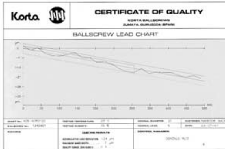
Fig. 1 Certificado de precisión de paso Lead accuracy certificate
